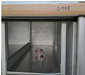
(Armoire de transport des DMR avec un test de souillure)
