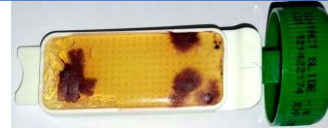
Test microbiologique positif avant lavage
