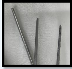
Image n°2: pincers charbonnées après utilisation du BICARJET®
